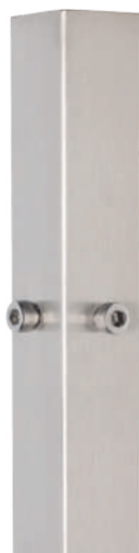
N31.B2471.4ES Stupek środkowy 40x40x981 mm, 4 otwory z gwintem M8, moc. w podłogę (aisi 304, syst. 40x40, satyna)
