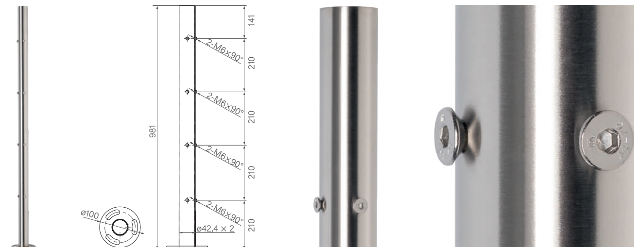
N31.B1620.4BS Stupek narożny fi 42,4 x 981 mm, 8 otworów z gwintem M6, moc. w podłogę (aisi 304, syst. 42,4, satyna)
